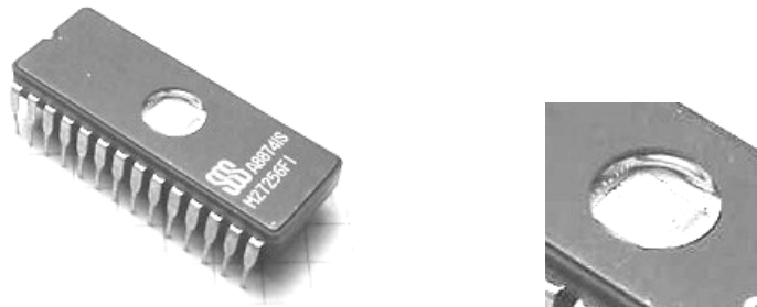
Slika 3.2.1. Izgled EPROM memorije u keramičkom kućištu sa prozorom za UV brisanje.
