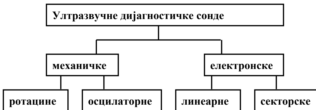
Сл. 7.5. Класификација ултразвучних дијагностичких сонди
